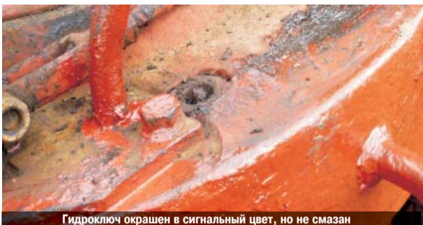
Гидроключ окрашен в сигнальный цвет, но не смазан
